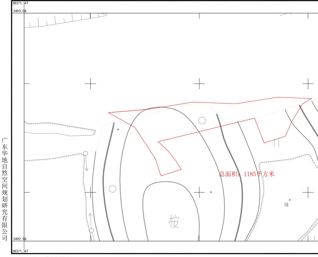
2025年4月数字化制图 2000国家大地坐标系,中央子午线114度 TD/T1008-2007土地勘测定界规程
